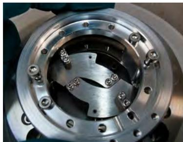
Fig. 1: Kollimator mit einseitig gekühlten Blenden angetrieben mittels Linearantrieb, Anordnung bei kleiner Öffnung (Bild: Frieder Müller)
