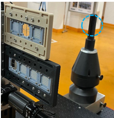
Fig. 1: Fluoreszenzdetektor (blauer Kreis) am ARES-Beschleuniger am DESY bei Studien zur FLASH-Therapie.
