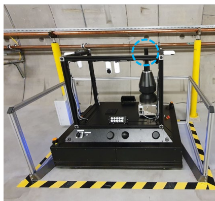
Fig. 2: Fluoreszenzdetektor (blauer Kreis) am European XFEL auf dem Roboter MARWIN4 zur Messung von Synchrotronstrahlung.
